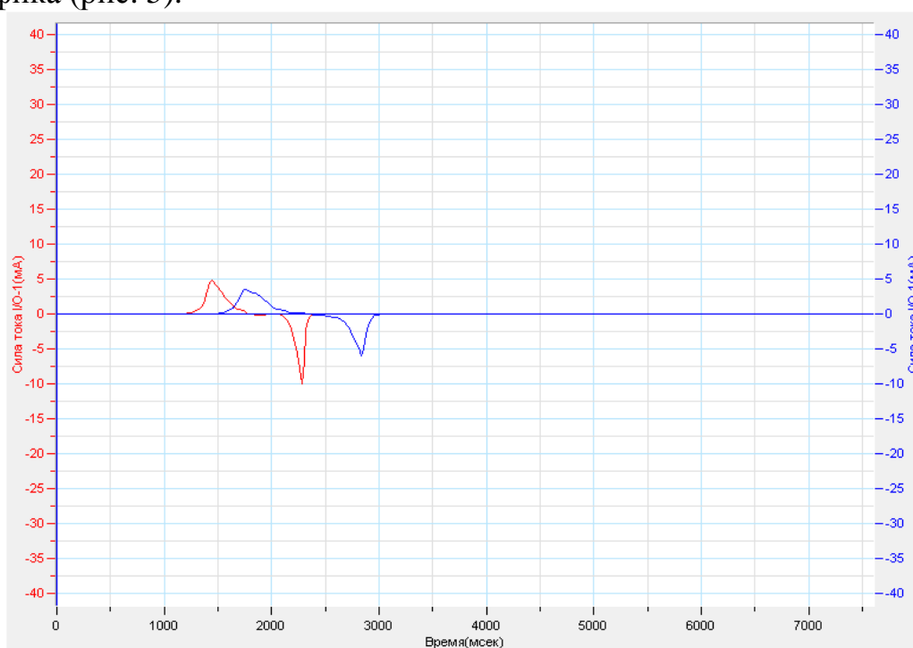
Рисунок 5. Графики зависимости силы индукционного тока от времени Эксп1 и Эксп3
